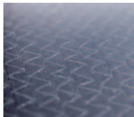
Struktura włókien węglowych w materiale CFK.
