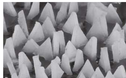
Optymalne ustawienie ziarna ściernego VICTOGRAIN
